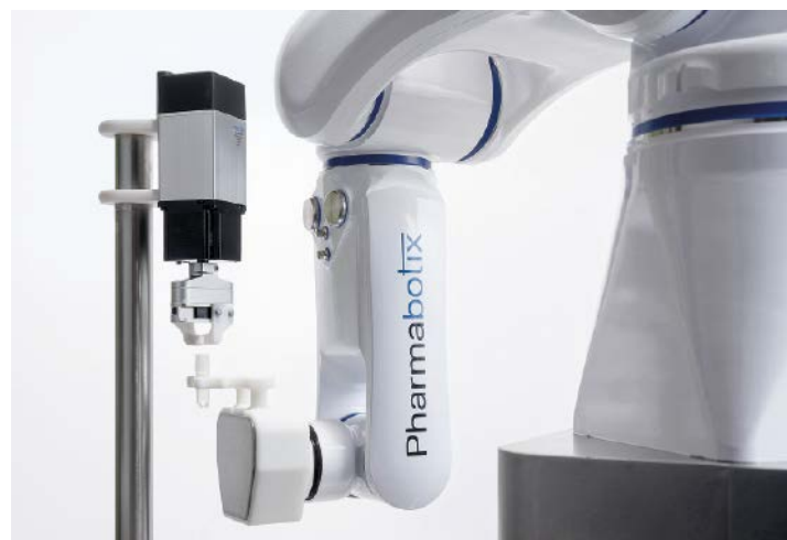
Abb. 2: Das Handling der Cryo Vials übernimmt ein hygienegerechter Industrieroboter Motoman HD8
