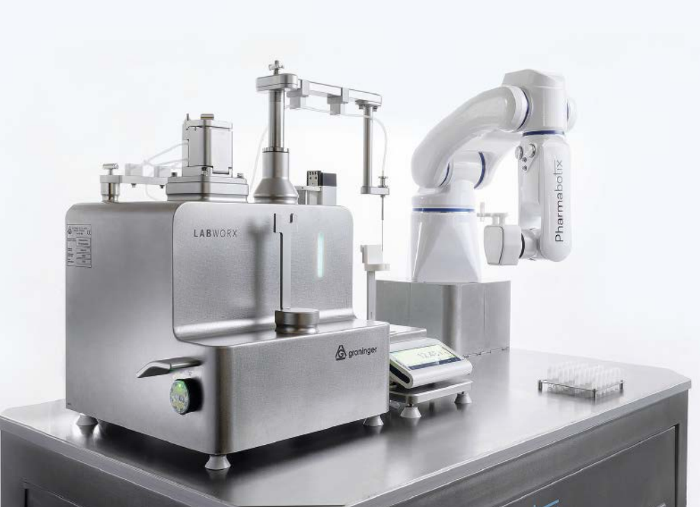
Abb. 1: Die Cryo Vials werden in einem Rack oder durch ein flexibles Zuführsystem bereitgestellt und durch den Roboter gehandhabt. Die Neuentwicklung kann automatisiert bis zu sieben Fläschchen pro Minute abfüllen, zukünftig auch mehr.
