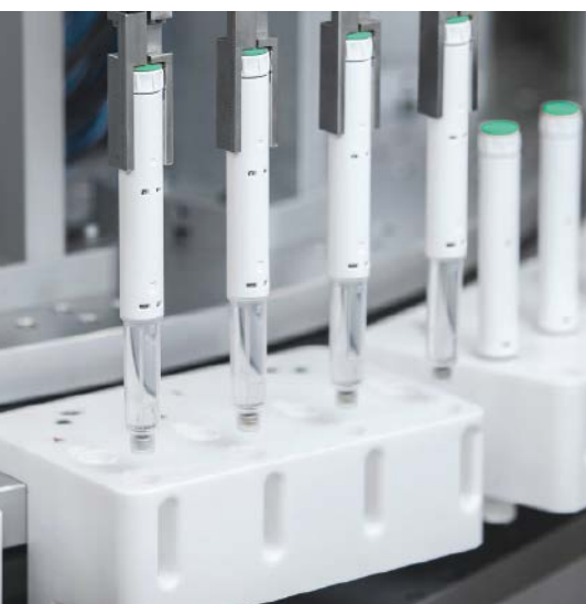
Abb. 1: Moderne Pen-Montagemaschinen bieten Unternehmen die Wahl zwischen manueller, halb- und voll-automatischer Montage bei schneller, werkzeugloser Umrüstung.
