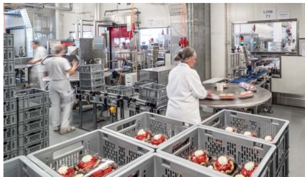
Bild: Im Bereich der verpackten Produkte können auch für sensible Produkte die Umgebungsanforderungen gesenkt werden
