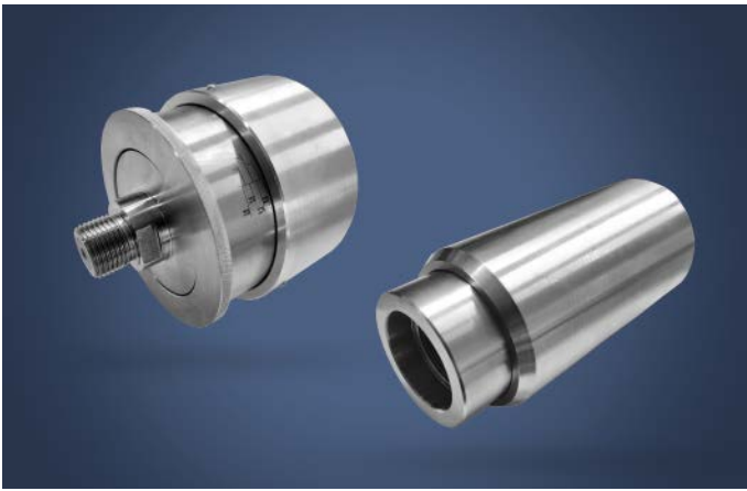
■ Abb. 2: Die Hysteresemagnet-Kupplungen von KBK rutschen im Fall einer Überlast sanft durch. Sie eignen sich damit ideal für den Einsatz an Schraubverschießern von Getränkeabfüllanlagen oder in Dehnfolien-Verpackungsmaschinen.
