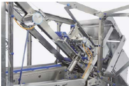
■ Abb. 2: Für Provisur Technologies ist ein offenes und hygienegerechtes Design ein zentrales Merkmal moderner Anlagen in der Lebensmittelverarbeitung.
