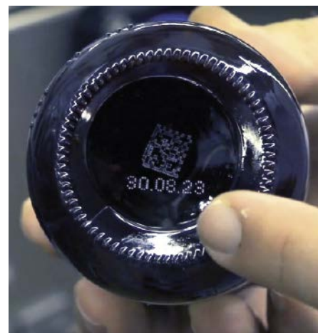
Abb. 2: Die Böden der Konfitürengläser sind mit dem MHD und für die Rückverfolgbarkeit mit einem QR-Code gekennzeichnet. Herausforderungen dieser Aufgabe waren die glatten Glasoberflächen und die meist dunkleren Glasinhalte.
