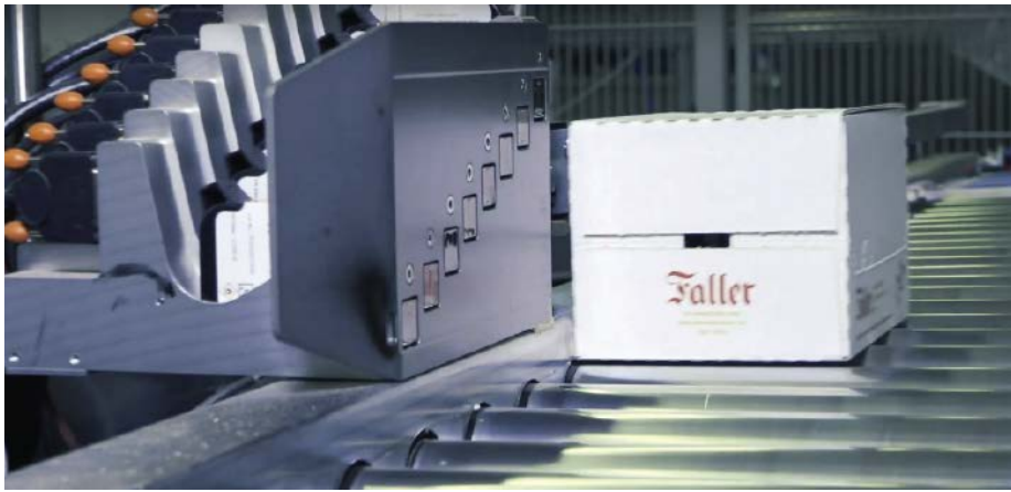
■ Abb. 3: Die Bedruckung der Kartons übernimmt der thermische Inkjet-Drucker Markoprint. Er kann bis zu acht Druckköpfe ansteuern, die bei einer Auflösung von 600 dpi eine Gesamtdruckhöhe von 100 mm realisieren.
