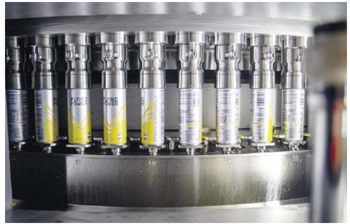
■ Abb. 4: Dank der neuen Variante des Modulfill Bloc kann Spitz einen höheren Hygienestandard gewährleisten als bei einem konventionellen Block.
