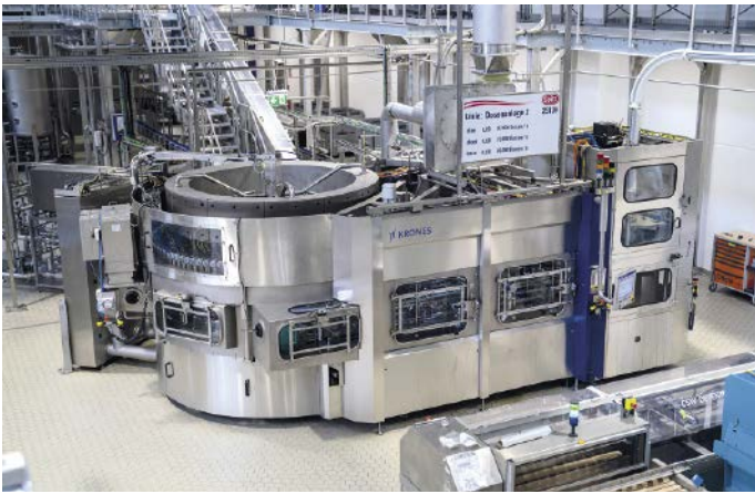
■ Abb. 3: Der Füller-Verschleißer-Block in hygienischer Ausführung Modulfill Bloc FS-C hat klare Pluspunkte bei den Themen Hygiene und Flexibilität – und ist bislang einzigartig am Markt.
