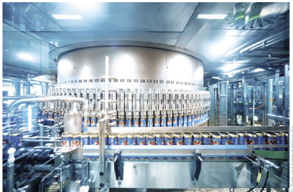
■ Abb. 3: Füller- und Verschleißeranteil der gemeinsamen Blocklösung Smartcan von KHS/Ferrum verfügen über ein optimiertes Hygienekonzept.
