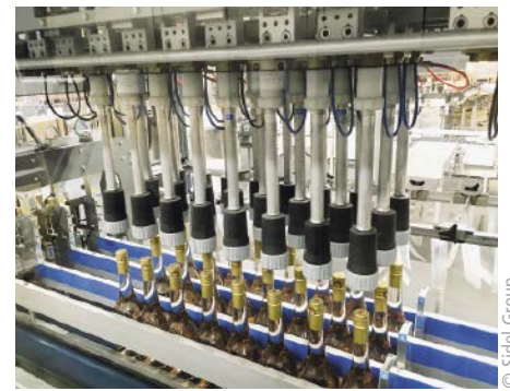
■ Abb. 3: Heute ermöglicht die End-of-Line-Lösung einen Ausstoß von 14.000 Flaschen pro Stunde. Die Partnerschaft zwischen Sidel und Perrin begann vor 25 Jahren, als die Abfüllgeschwindigkeit noch bei 6.000 Flaschen pro Stunde lag.
