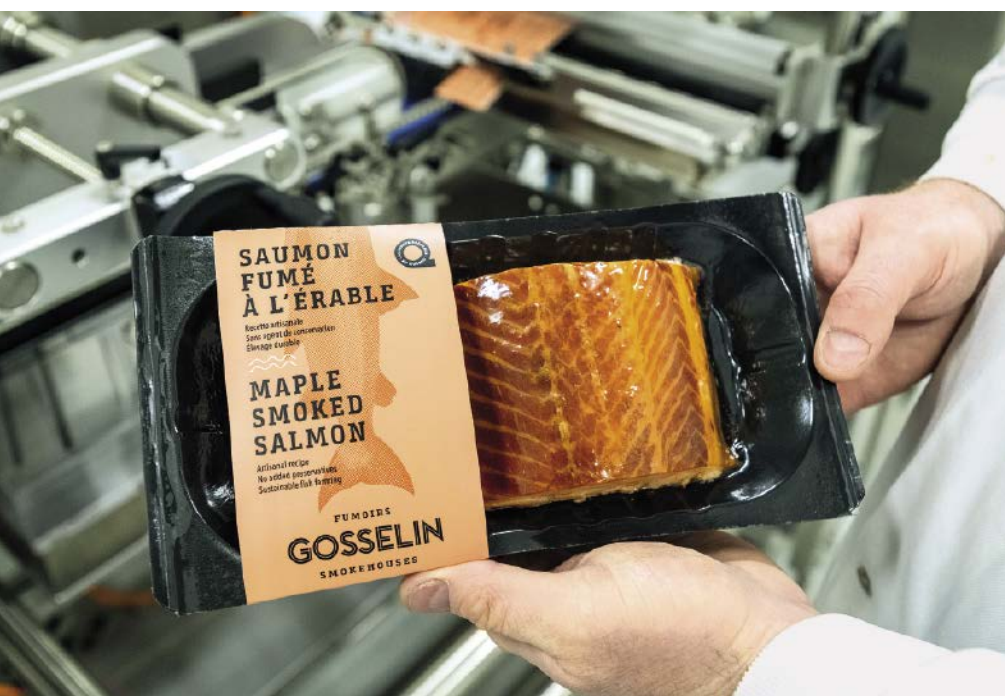
■ Abb. 1: Die Verpackung aus der Multivac Verpackungsmaschine R 105 MF präsentiert den Maple-Räucherlachs hoch transparent auf einer recyclingfähigen Unterfolie, tiefgezogen zu einer schwarz eingefärbten Schale, hinter einer sehr dünnen, flexiblen Oberfolie.
