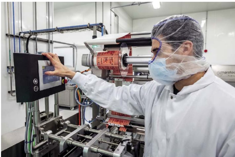
■ Abb. 3: Die Verpackungsmaschine R 105 MF kann unterschiedliche Folienarten, wie Weich- und Hartfolien, aber auch Papier-Verbundmaterialien verarbeiten und ermöglicht ein schnelles Umrüsten auch auf Vakuum- und MAP-Packungen.
