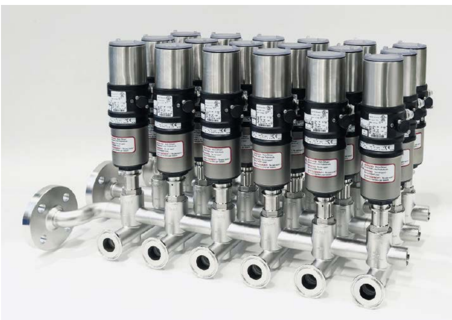
■ Abb. 3: Das Schweißen verbindet die Anschlussstutzen direkt zu kompakten Einheiten. Der Ventilblock mit sechs Eingängen, drei Ausgängen und 18 Ventilen verteilt sechs Medien in drei verschiedenen Anlagenbereiche.
