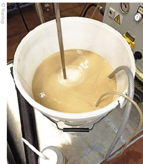
■ Abb. 2: Vor der Isolierung der Hefeinhaltsstoffe muss die Hefeemulsion zunächst standardisiert werden.
