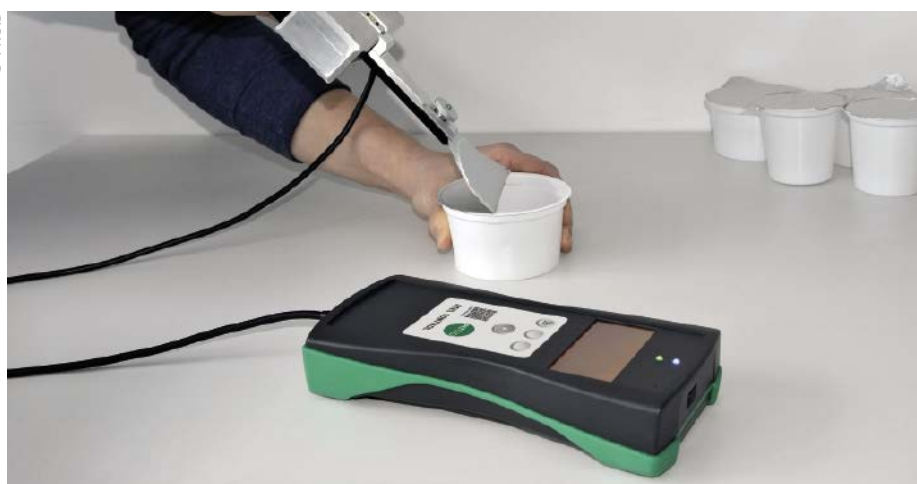
■ Abb. 2: Das Peel Control im Einsatz zur schnellen und einfachen Messung der Öffnungskräfte einer Verpackung.
