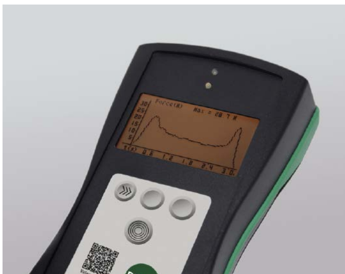
■ Abb. 3: Die Anzeige auf dem Geräte-Display erlaubt bereits erste Aussagen zur Verbraucherfreundlichkeit. Nach Übertragung auf einen PC ist die statistische Auswertung der Daten dann einfach möglich.
