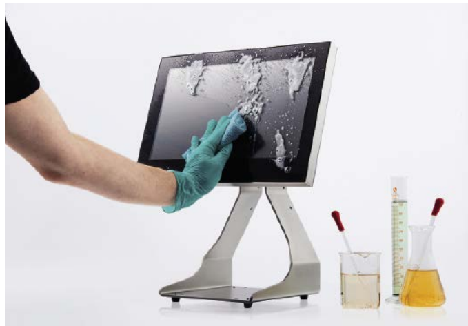
■ Abb. 2: Das Gehäusematerial V4A des Pro-V-Pad Steel IP69K bietet zuverlässigen Schutz gegen chlorhaltige Medien, wie sie in vielen der gängigen Reinigungs- und Desinfektionsmittel enthalten sind – und damit eine überzeugende Beständigkeit.
