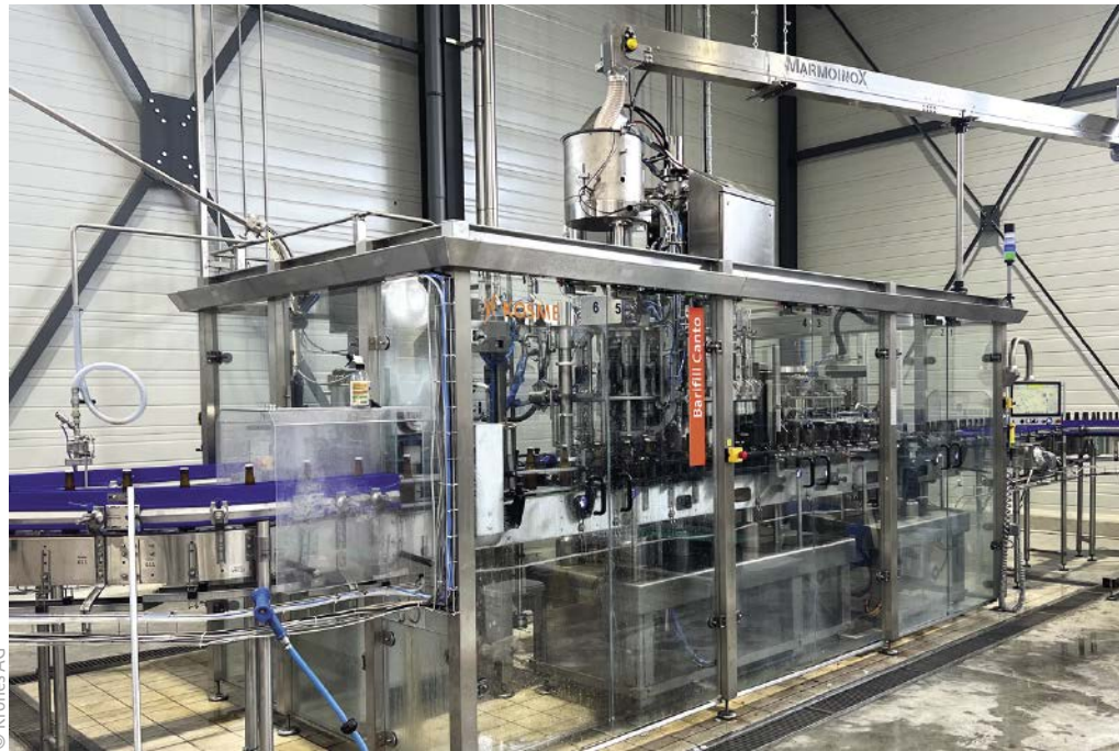
■ Abb. 2: Herzstück der neuen Abfülllinie ist der Kombi-Füller Barifill Canto, der sowohl Glasflaschen als auch Dosen verarbeitet. Kleine Brauereien und Wein-Abfüller gewinnen so maximale Flexibilität in der Behälterwahl, ohne dafür in zwei unterschiedliche Füller zu investieren.
