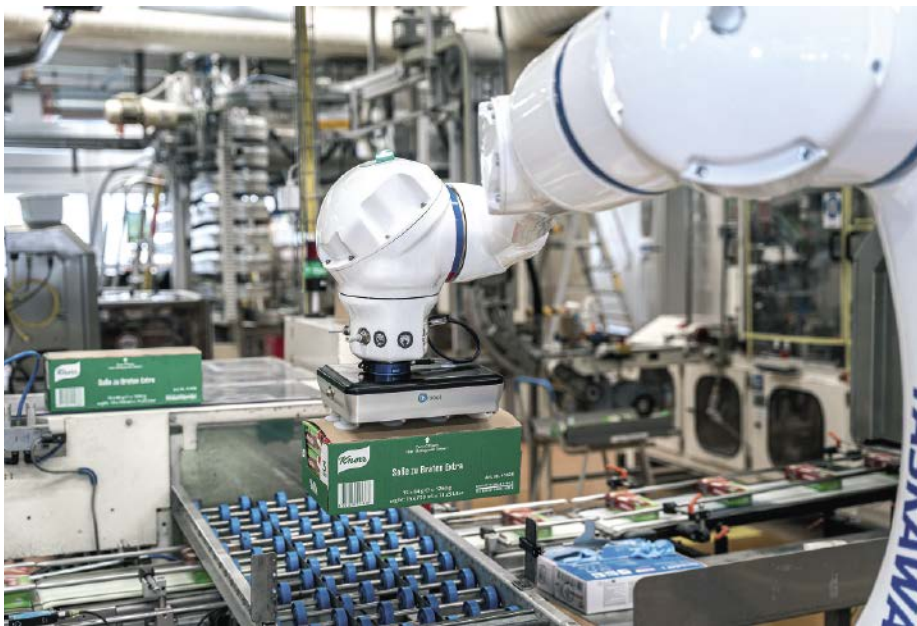
Abb. 2: Vom Greifer angesaugt, werden die Produkte von der Rollenbahn entnommen.
