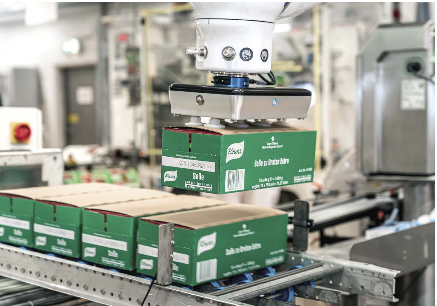
■ Abb. 1: Die Produkte werden auf einer Rollenbahn „angeliefert“ (gefördert) und aufgestaut.
