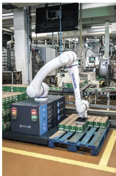
Abb. 3: Die Produkte werden nun lagerichtig auf der Palette positioniert (palettiert).
