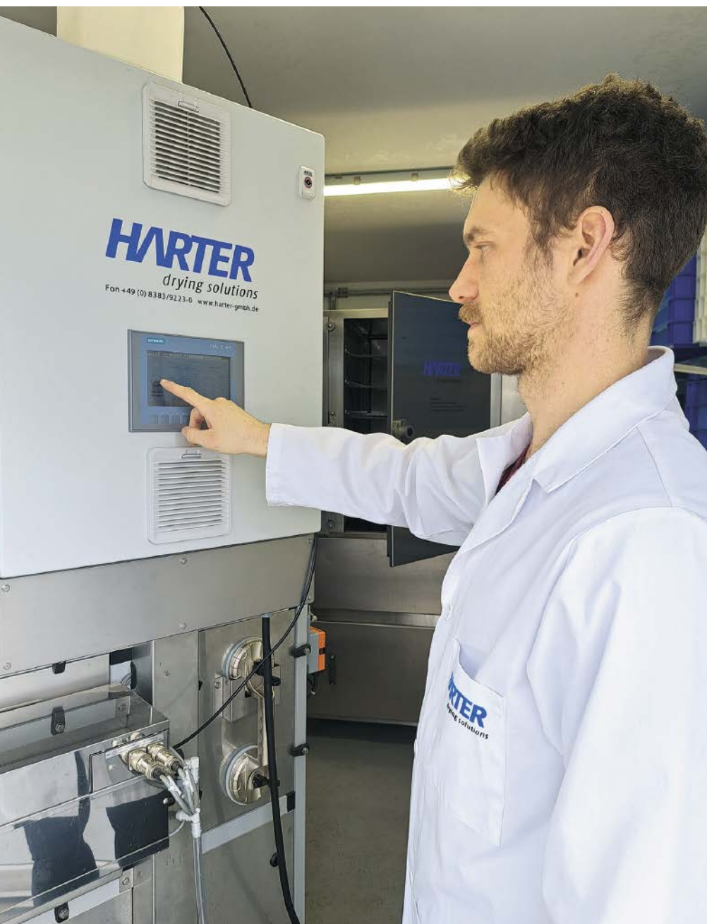
■ Abb. 1: Die Steuerung am Hordentrockner im Technikum ermöglicht Fabian Baur individuelle Parameter für die verschiedenen Versuchsdurchläufe einfach und schnell zu ändern. Die beste ermittelte Variante wird schlussendlich als Rezept hinterlegt.
