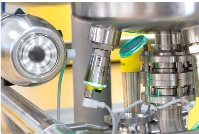
■ Abb. 3: Glänzende Oberflächen: Auch perfekte Hygiene verbindet alle Vega-Lebensmittelsensoren, gleich ob Pro- oder Basic-Serie: Ihre Materialien sind nach FDA und EG 1935/2004 zugelassen und geprüft.
