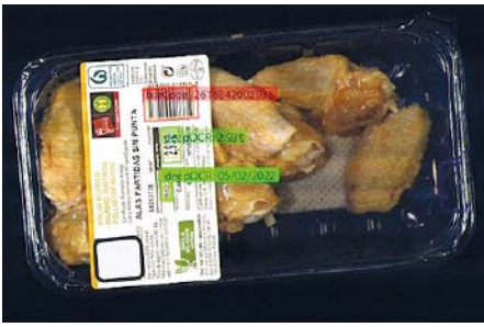
■ Abb. 2: Ein anderes Anwendungsszenario ist die Inspektion der Etikettierung und die Prüfung, ob sich Falten unterhalb des Etiketts gebildet haben.
