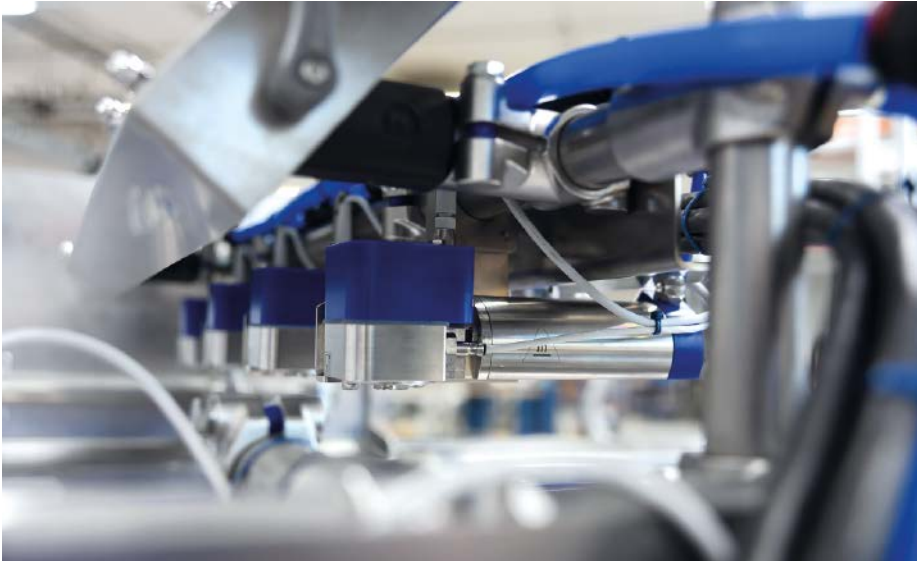
■ Abb. 2: Technotrans entwickelte in enger Zusammenarbeit mit dem Kunden eine anwendungsspezifische Sprühanlage auf Basis der Spray.xact food-Baureihe.
