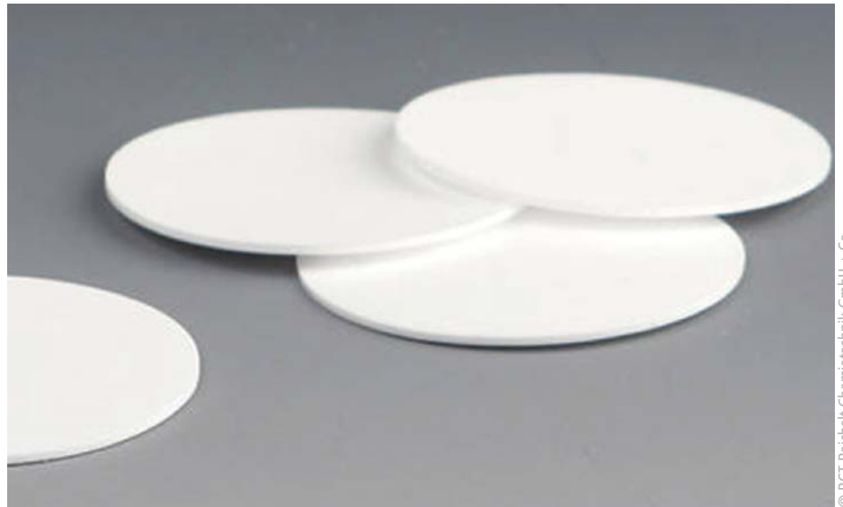
■ Abb. 3: Die zu filtrierenden Medien durchströmen das Sieb bzw. Siebgewebe, dessen Durchlässigkeit durch die Maschenweite vorgegeben wird, analog zu der Porengröße feinerer Filtermembranen.
