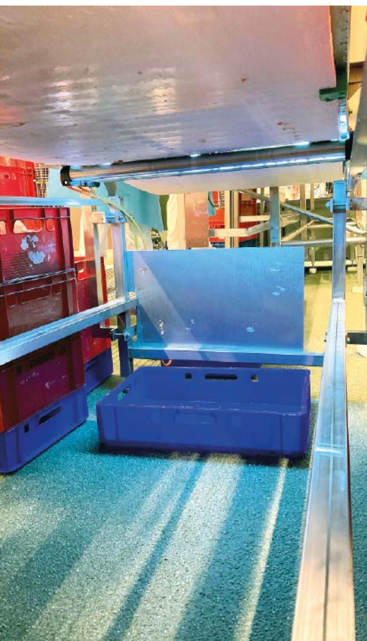
Abb. 1: Mit T2018 UVC-Bandentkeimern werden die Oberflächen der Arbeitsbänder am Tag während des laufenden Produktionsprozesses chemiefrei entkeimt.
