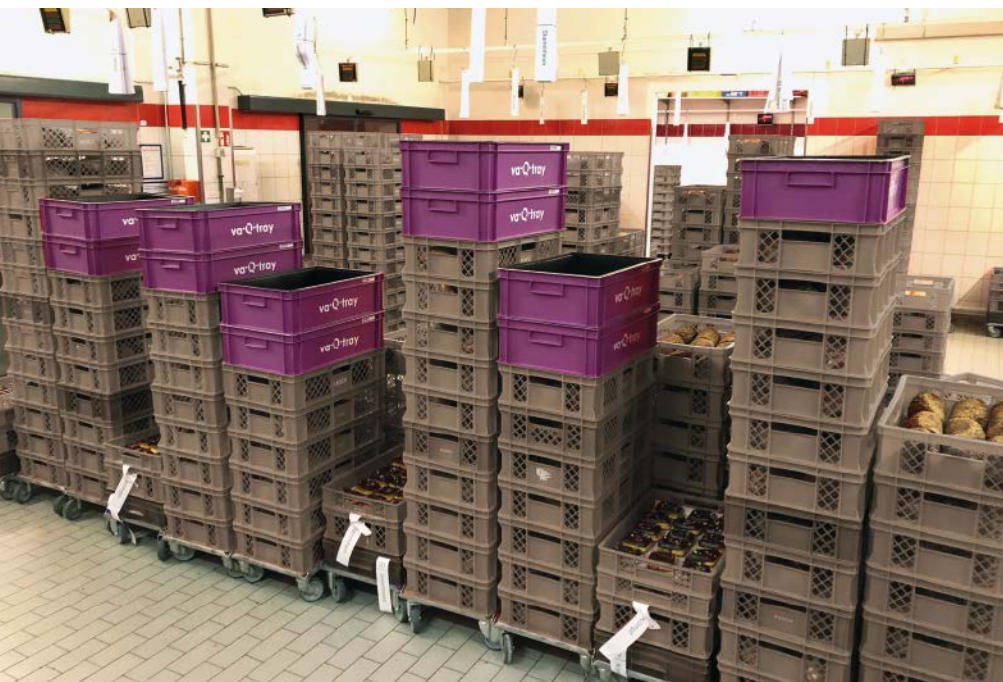
■ Abb. 1: Die vakuumisolierten Boxen ermöglichen den temperaturstabilen Transport von Lebensmitteln zwischen -30 °C und +70 °C. Aufgrund der Normgrößen nach Euronorm sind sie stapelbar und einfach in bestehende Logistikprozesse zu integrieren.
