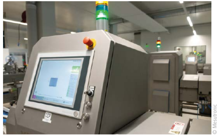
■ Abb. 3: Das Easyscope Röntgeninspektionssystem von Mesutronic erlaubt die präzise Fremdkörper-Detektion in den Qualitätsbackwaren trotz metallischer Verschlüsse an der Primärverpackung.
