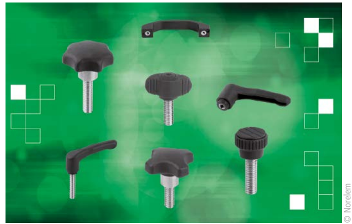
■ Abb. 3: Die metall-detektierbaren Produkte von Norelem sind aus einem speziellen magnetischen Kunststoff gefertigt, der für Metalldetektoren leicht erkennbar ist. Zu den Produkten zählen Rändelknöpfe, Kreuz- und Sterngriffe, Klemmhebel sowie Flügel- und Bügelgriffe.
