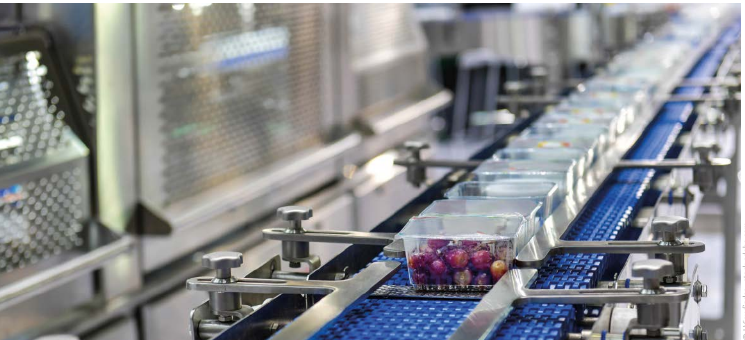
■ Abb. 1: Produktionsanlagen wie Sortiermaschinen und Laufbänder können Verunreinigungen verursachen. Durch Unachtsamkeit oder Fehler gelangen kleine Splitter beschädigter Bauteile oder lose Befestigungselemente in den Herstellungsprozess.
