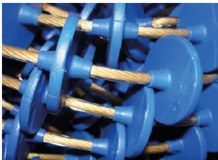
■ Abb. 2: Für Anwendungen im Lebensmittelbereich bestehen die Fördererlemente aus blauem Kunststoff.
