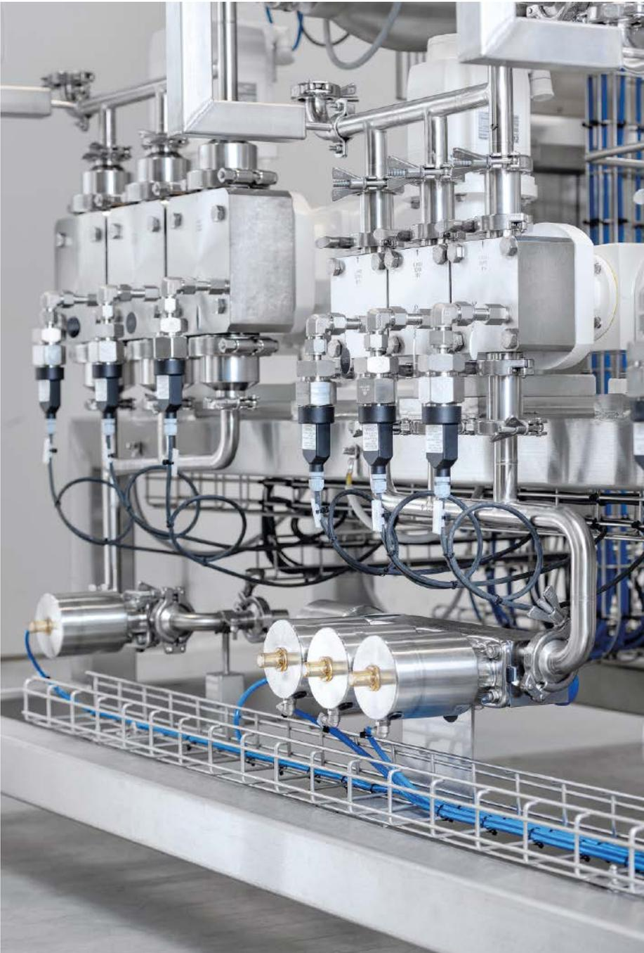
Um diesen großen Stellbereich flexibel abdecken zu können, sind fünf Pumpen vom Typ Ecodos hygienic in die Anlage integriert, die über mechanisch angelenkte mehrlagige Sandwich-Sicherheitsmembranen angetrieben werden.
