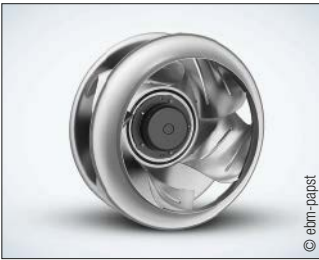
Abb. 2: Die RadiPac EC-Radialventilatoren von ebm-papst sind speziell für Filter Fan Units in Reinräumen konzipiert. Das neu entwickelte Laufrad mit seinen fünf geometrisch anspruchsvoll gestalteten Laufradschaufeln reduziert die Strömungsverluste drastisch.
