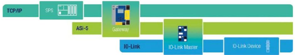
Durch das ASI-5/ASI-3 Feldbus Gateway von Bihl+Wiedemann erfolgt eine physische Entkopplung zwischen TCP/IP und ASI-5 sowie ASI-5 Safety, sprich der Feldbus- und der Feldebene.
