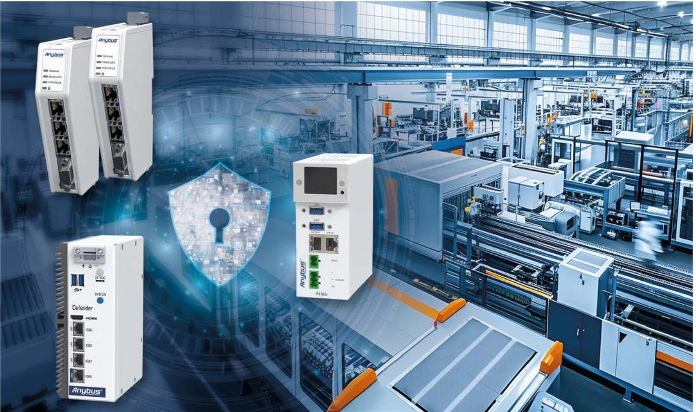
Schon heute gibt es verschiedene Tools für eine sichere Anlagenkommunikation: Anybus Atlas für kontinuierliche Netzwerkdiagnose, Anybus Defender als Firewall für die Steuerung und Überwachung der Kommunikation sowie Anybus Gateways zur logischen und physikalischen Segmentierung von Netzwerken.
