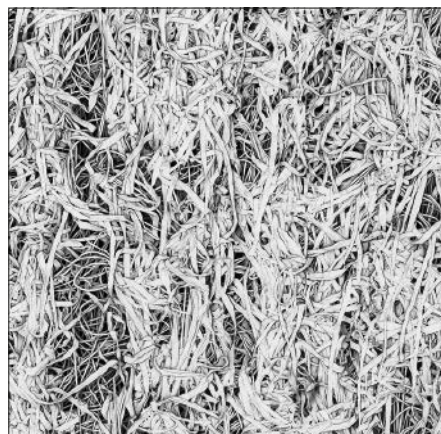
Abb. 13 a: Polyester-Zellstoff-Vlies, A-Seite, 90-fach, REM YL
